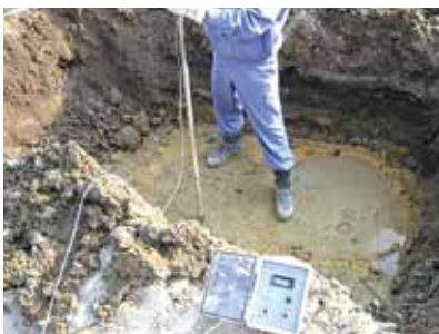
ミキシングテスターによる比抵抗測定
