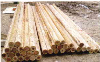
ウルトラウッドコラム工法で使用する木製芯材
